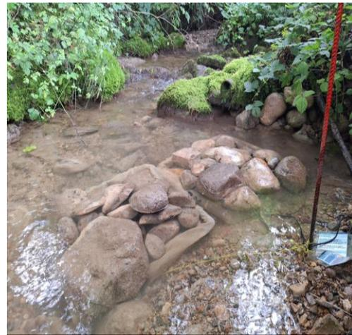
Abbildung 2-7: «Pritchard trap» (PT) nach dem Einsatz in das Substrat des Wiesenbachs.
