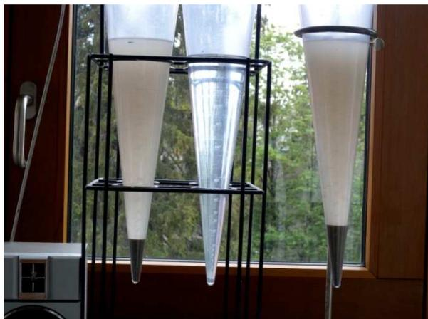
Abb. 3: Versuchsanordnung mit Imhofftrichter
