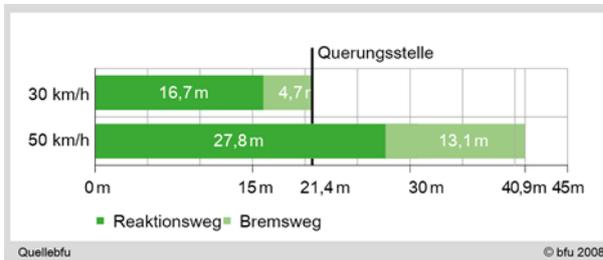
Anhalteweg bei 30 km/h und 50 km/h bei trockener Fahrbahn (bfu)
