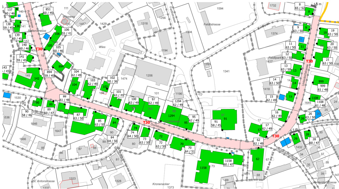
Lärmbelastung im Perimeter mit der Einführung von Tempo 30 (grün = IGW eingehalten, gelb = IGW überschritten)
