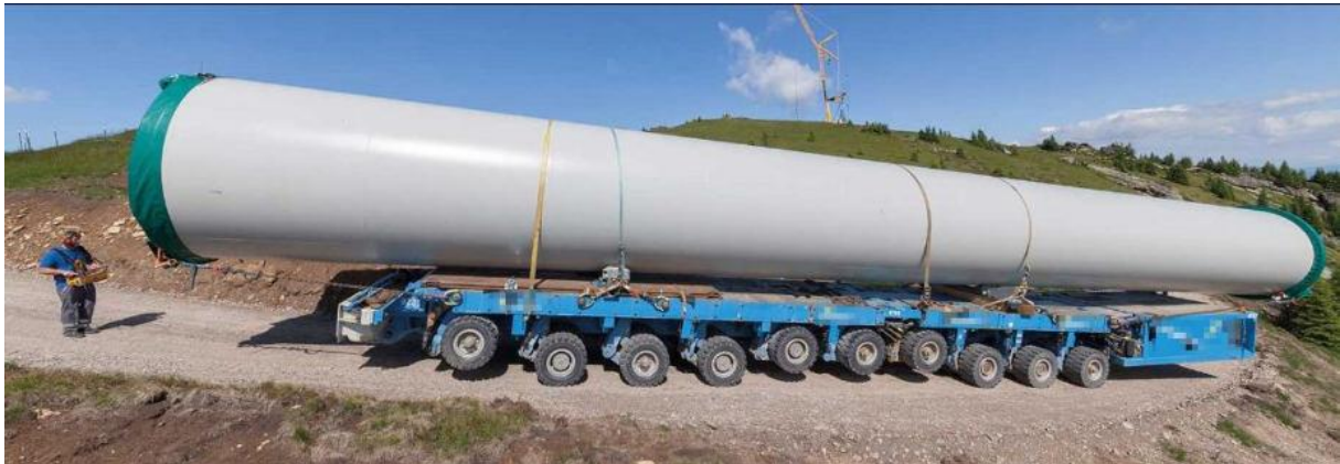
Abbildung 12: Transport Turmelement mit SPMT
